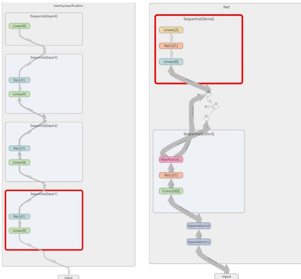
图 3.8 左边为全连接网络模型图 右边为卷积网络模型图
